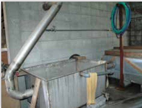
図6 伝統的樟脳生産の蒸留冷却装置
